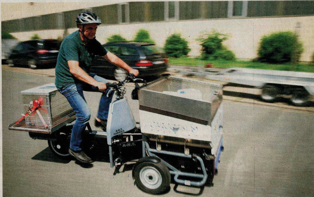
Udo Göser auf der Test-„Ameise“ der Firma Klöpffer: Das Lastenrad ist für 25 km/h und 295 Kilo Gesamtgewicht zugelassen.
